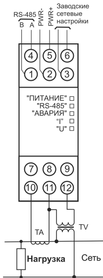
Рисунок Б.4 – Подключение прибора к однофазной сети через согласующие трансформаторы тока и напряжения
