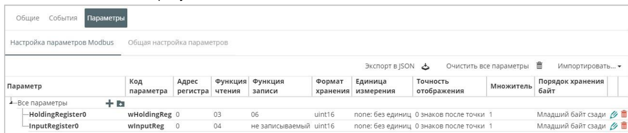
Рисунок 5.10.11 – Настройка параметров Modbus
