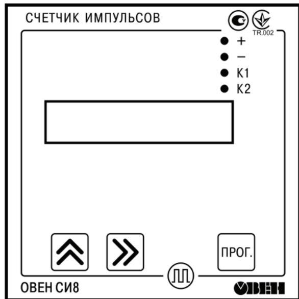
Рисунок 3.6 – Внешний вид лицевой панели прибора для корпусов настенного (Н) и щитового (Щ1) креплений
