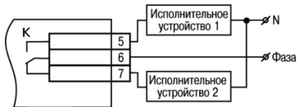
**Рисунок Б.7 – Схема подключения нагрузки к ВУ типа Р**
