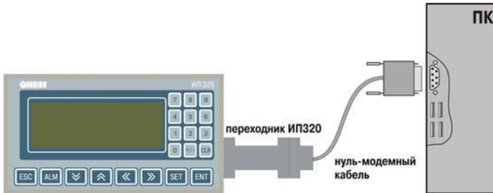
Рис. 5.1. Схема подключения интерфейса RSC232 (а) и интерфейса RSC485 (б) для конфигурирования панели ИП320
