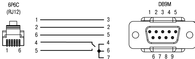
Рисунок В.2 – Схема кабеля КС3 для подключения модема к ОВЕН ПЛК154 по интерфейсу RS-232 Debug
