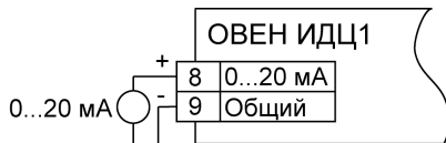
Рисунок 3.4 – Схема подключения ко входу прибора датчиков с сигналами тока от 0 до 5 мА, от 0 до 20 мА, от 4 до 20 мА
