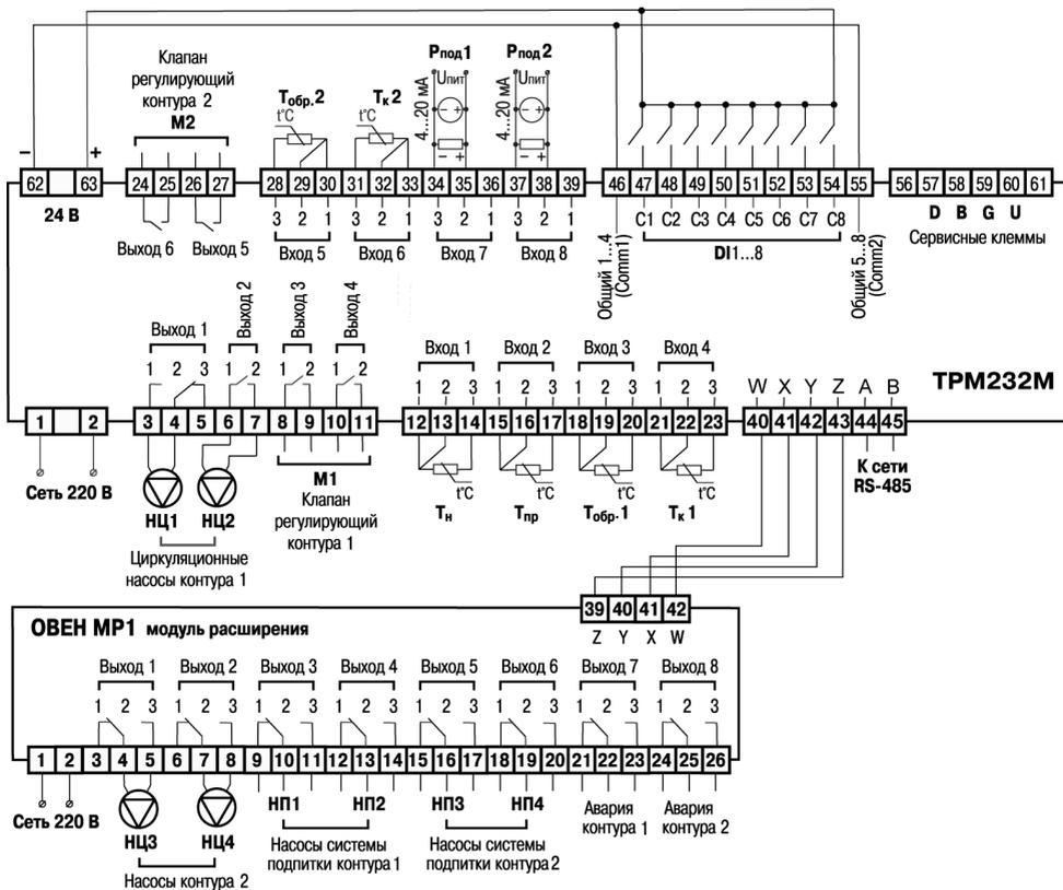
Рисунок 6.4 – Схема подключения для конфигурации № 4
