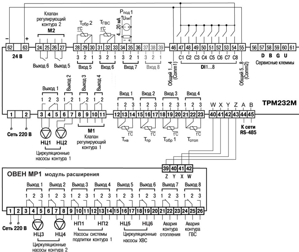
Рисунок 6.5 – Схема подключения для конфигурации № 5
