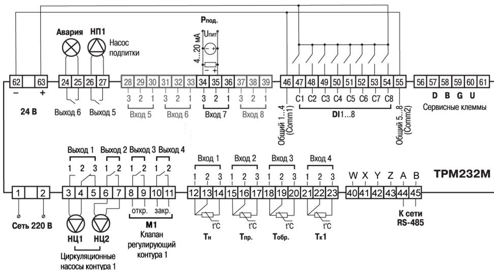
Рисунок 6.1 – Схема подключения для конфигурации № 1
