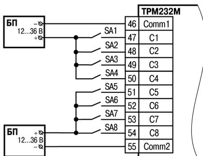
Рисунок 6.6 – Подключение датчиков к дискретным входам
