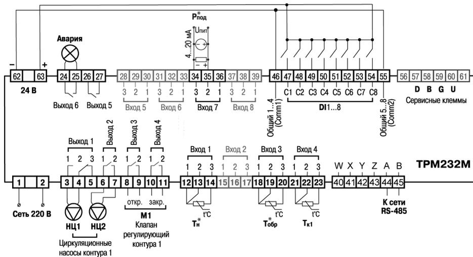
Рисунок 6.2 – Схема подключения для конфигурации № 2
