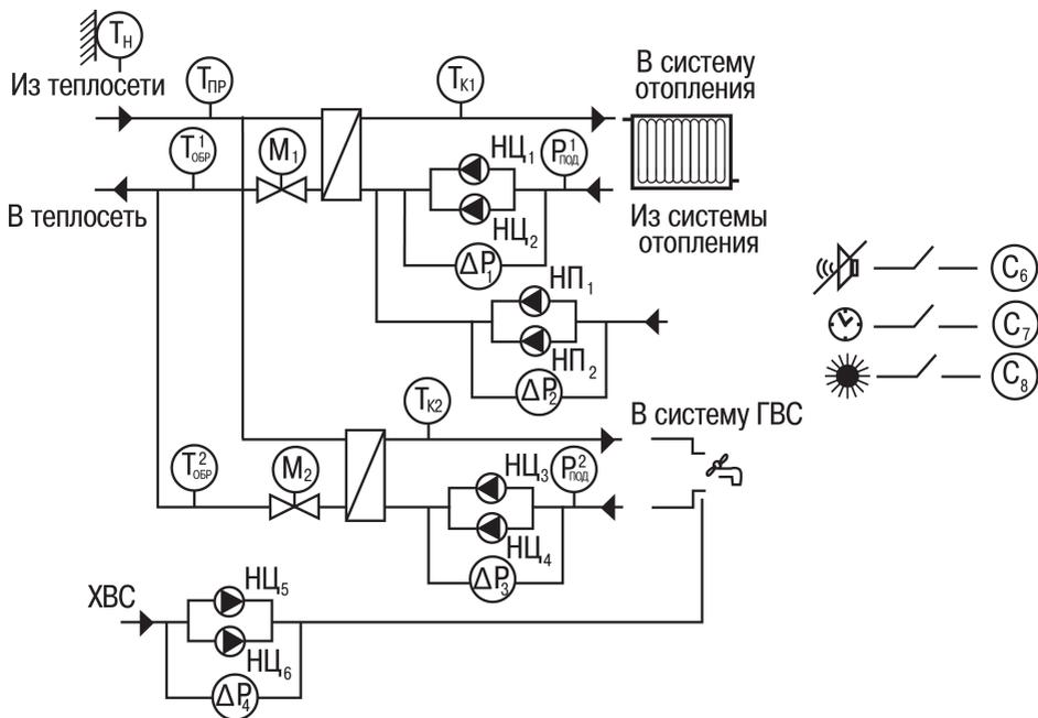
Рисунок 4.5 – Функциональная схема Конфигурации № 5
