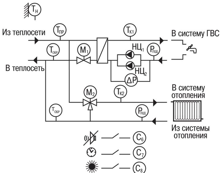
Рисунок 4.3 – Функциональная схема Конфигурации № 3
