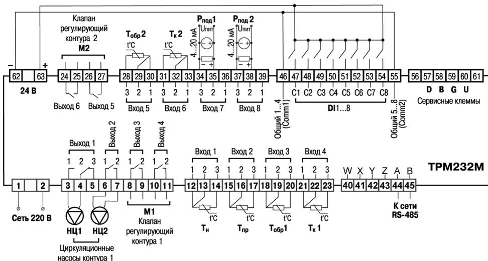
Рисунок 6.3 – Схема подключения для конфигурации № 3
