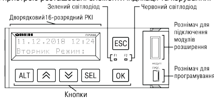
Рисунок 10 – Лицьова панель пристрою (кришку відсіку підключення модулів умовно не показано)
