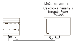
Рисунок 9 – Типова схема підключення для PR100 у режимі Slave
