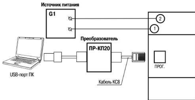
Рисунок 6.9 – Схема подключения к ПК (через преобразователь PR-KP20)
