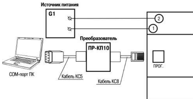
Рисунок 6.8 – Схема подключения к ПК (через преобразователь ПР-КП10)
