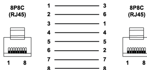
Рисунок 6.2 – Схема перехресного кабелю для підключення пристрою по мережі Ethernet
