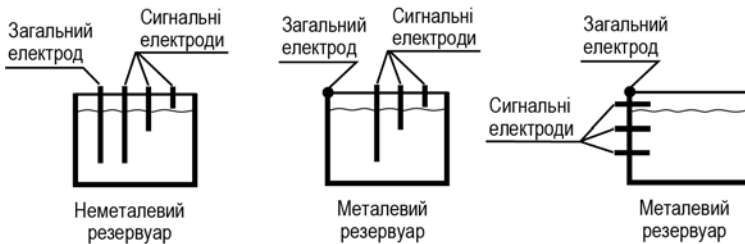
Рисунок 5.4 – Приклади установлення кондуктометричних зондів
